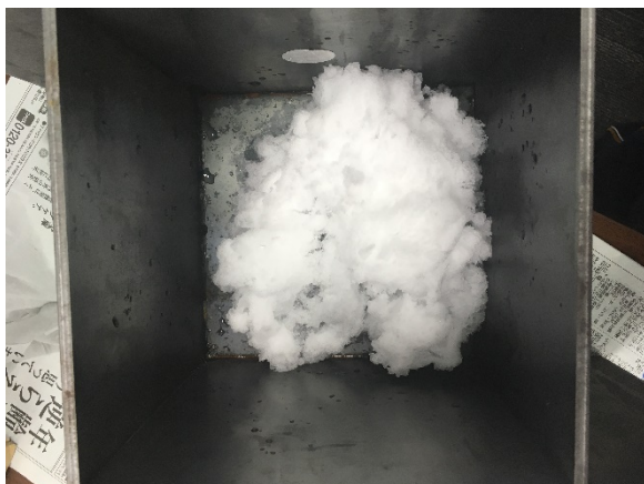
図-9 雪の融解量を測定中の実験装置（内部）
