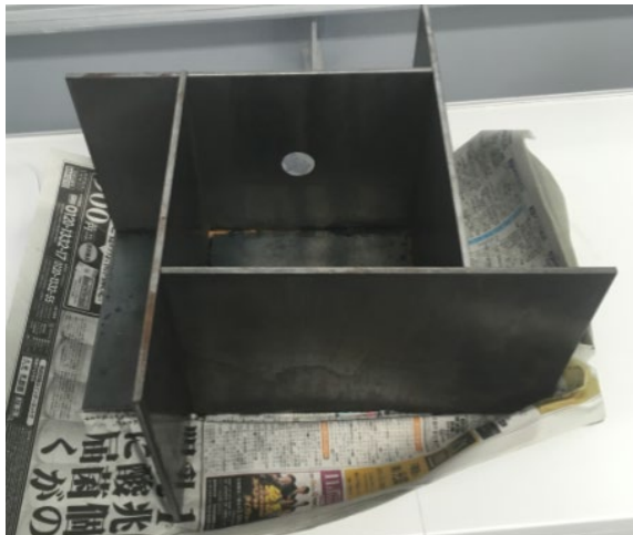
図-8 雪の融解量を測定する実験装置
