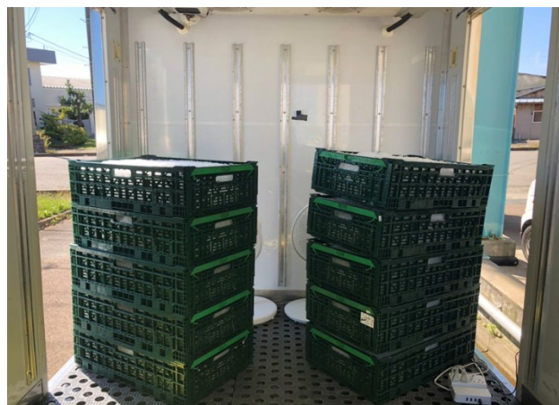
図-9 雪冷媒を縦に積上げて設置した状態
