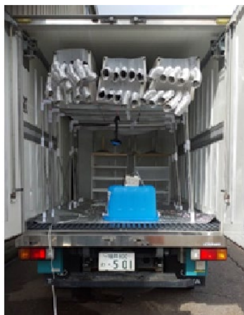
図-13 冷蔵トラック実車に設置した雪冷熱装置
